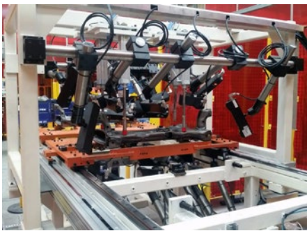
Actual Bluewrist inspection cell
